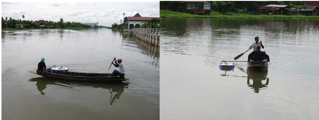
ภาพที่ 4 การวัดปริมาณน้ำในลำน้ำด้วยเครื่องวัดปริมาณการไหลในลำน้ำ
